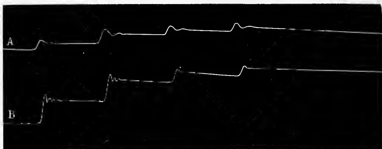
Fig. 66. — A et B, pulsations recueillies dans deux tubes branchés sur un même réservoir comme les artères sur l'aorte. — A, tube long. — B, tube court.
